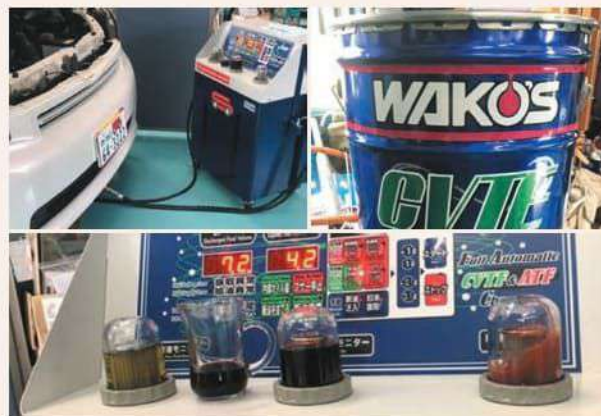
▲性能回復整備に使用する機器とその様子
